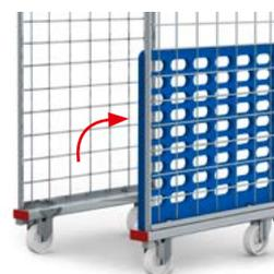
**Dotazione di serie:** telaio inferiore a forma di Z con telaio in tubo quadrangolare e cappucci terminali sagomati in verde (davanti) e rosso (dietro). Due parti laterali costituite da telaio a tubo tondo con reticolo metallico. Fondo ribaltabile in lamiera o in plastica colore blu segnale RAL 5005. Incl. 2 cinghie di fissaggio in tessuto.
